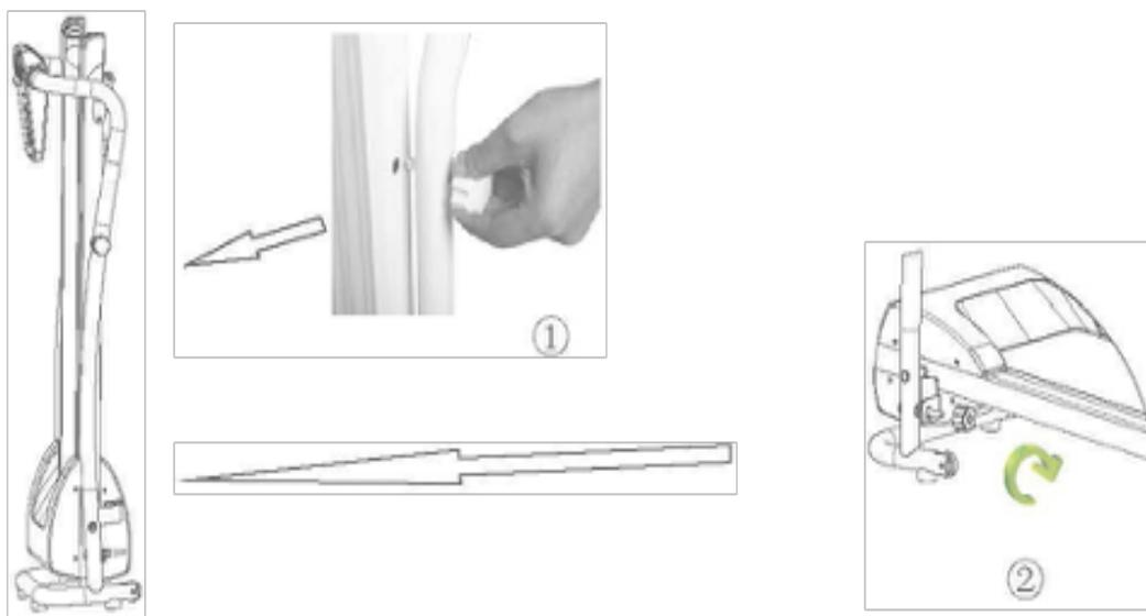
Потяните пружинный болт, как показано на рисунке, и медленно опустите беговую поверхность вниз. Затем надежно затяните ручку снизу.
