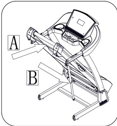
Приподнимите и зафиксируйте основную раму в положение А, пока не услышите звук, что опора В зафиксирована.
