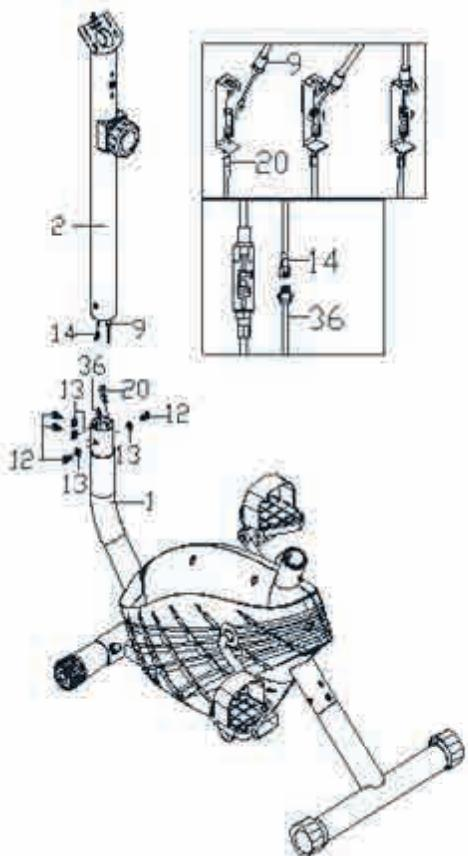
3. Снимите 4 болта с шестигранной головкой (12) и 4 волновые пружины (13) с основания (1) универсальным гаечным ключом. Подсоедините провод датчика из основания (36) к проводу удлинителя (14). Вставьте трос (9) в паз фиксатора (20). Вставьте стойку руля (2) в основание (1) и закрепите четырьмя болтами с шестигранной головкой (12) и четырьмя волновыми пружинами. Затяните болты универсальным гаечным ключом.
