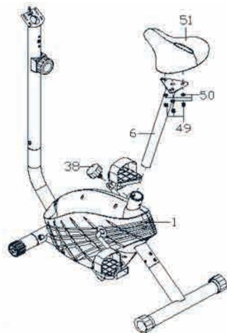
4. Снимите три плоские шайбы (50) и три гайки (49) с нижней стороны сиденья (51). Прикрепите сиденье к стойке (6) снизу снятыми ранее шайбами и гайками и затяните шестигранным ключом с крестообразной отверткой. Вставьте стойку (6) в основание (1) и прикрепите ручку для регулировки высоты сиденья (38) — поверните ее по часовой стрелке, чтобы зафиксировать сиденье.
