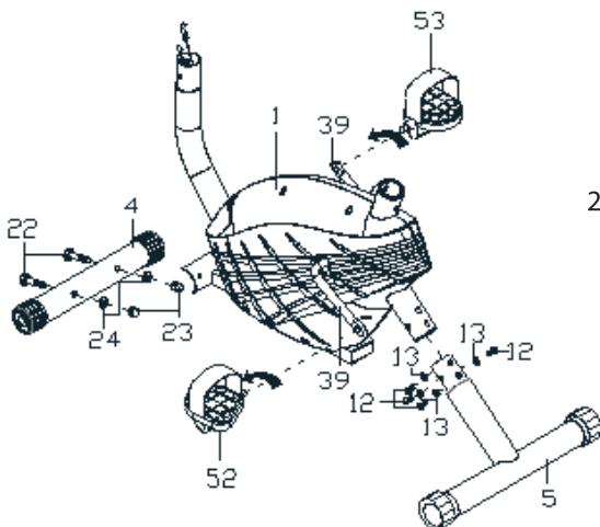
1. Прикрепите передний стабилизатор (4) к основанию (1) двумя болтами (22), двумя дуговыми шайбами (24), двумя колпачковыми гайками и затяните. Прикрепите задний стабилизатор (5) к основанию (1) шестигранным болтом (12) и дуговой шайбой (13).
